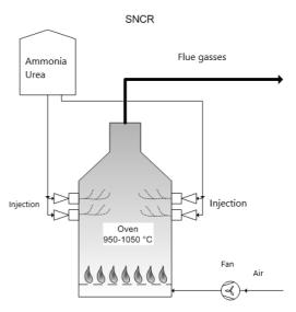
Figure I-1. Scheme SNCR (Emis: energie- en milieu-informatiesysteem voor het Vlaamse Gewest n.d.)
